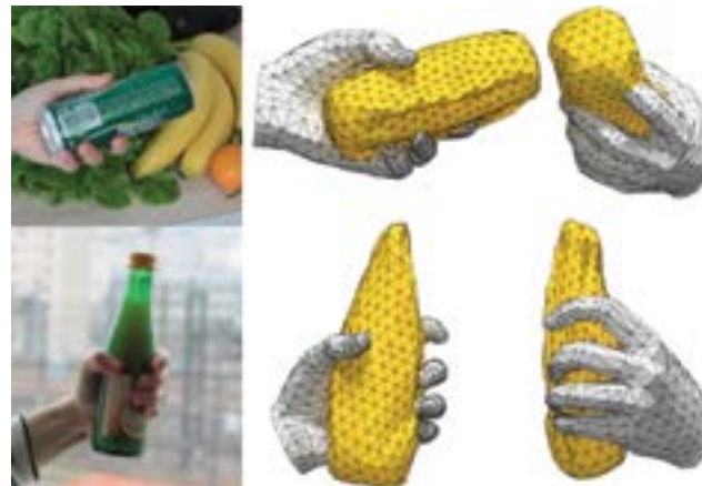
Rekonstruktion von realistischen Hand- und Objektinteraktionen durch Erlernen eines Modells, welches die Handhaltung und -form zusammen mit der Objektform durch Einhaltung physikalischer Einschränkungen erkennt.
