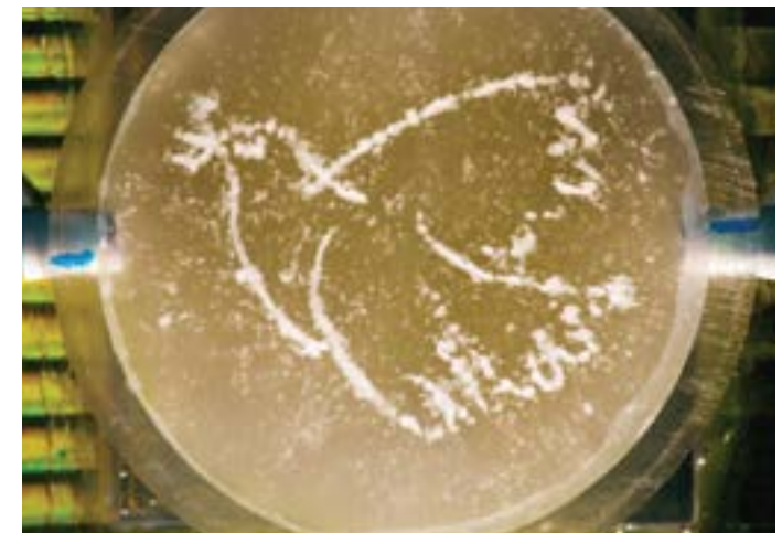
Mit Hilfe des akustischen Hologramms wurde das Profil des Ultraschalldrucks so geformt, dass sich Partikel als Picassos Friedenstaube anordnen.
