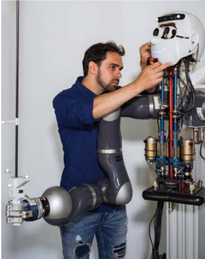
Roboter Apollo lernt, wie man eine Stange balanciert. Mit einem Kamerasystem scannt der humanoide Roboter kontinuierlich seine Umgebung, zweihundertmal pro Sekunde, und erzeugt so ein 3D-Bild seiner Umgebung. Anschließend berechnet er die Bewegungsabläufe, um die Stange so perfekt wie möglich zu balancieren.
