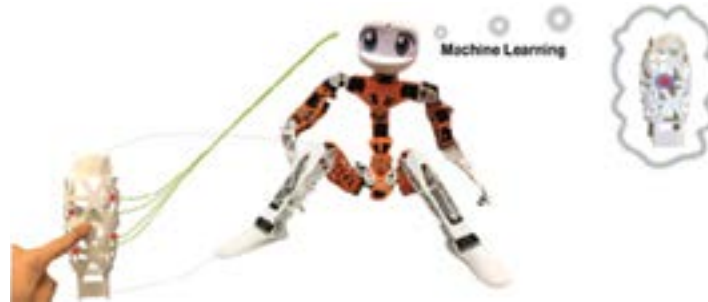
Das neue Gliedmaß (links) des Poppy Roboters (Mitte) ist mit wenigen Verformungssensoren ausgestattet. Maschinelles Lernen ermöglicht die Stärke der Kraft und deren Position präzise zu erkennen.
